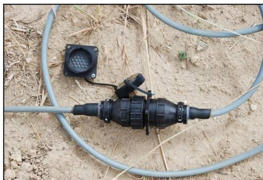
Connessione tra le sezioni di cavi multipolari
