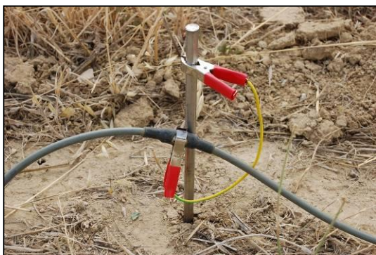
Connessione tra cavi multipolari ed elettrodi in acciaio inox
